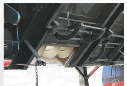
Sin fin inferior del sistema de descarga.
