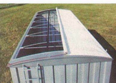
Sistema de lona mecanizada accionada desde el exterior de la unidad, fácil cierre y apertura de la misma y perfecto cierre no permitiendo la entrada de agua.
