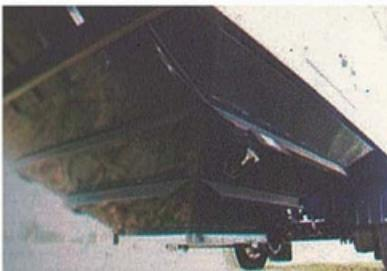
Boquillas inferiores de doble cremallera de acero tratado y guías con rodamientos blindados.
